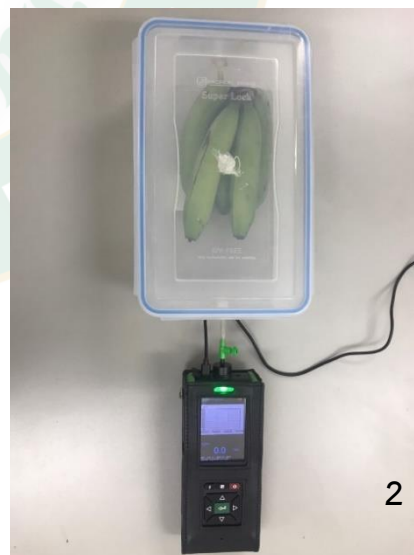
ภาพที่ 17 การวัดแก๊สเอทิลีนของกล้วยหอมทองดิบ (1) กล้วย 2 ผล ในกล่อง 2.5 L (2) กล้วย 5 ผล ในกล่อง 5 L
