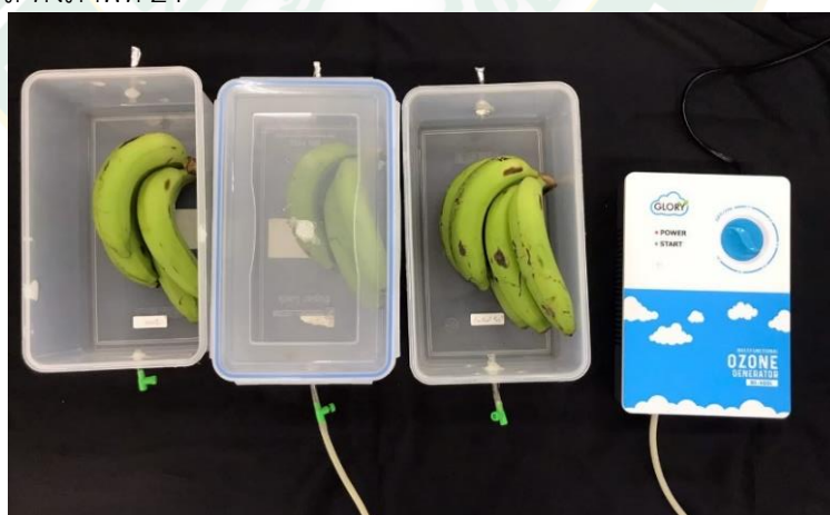
ภาพที่ 24 ตัวอย่างการรมกล้วยหอมทองโดยแก๊สโอโซน
