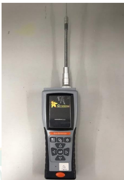
ภาพที่ 49 เซ็นเซอร์วัดแก๊สโอโซน (O 3 )
