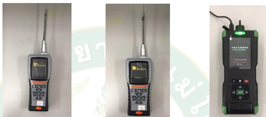
ภาพที่ 14 เครื่องวัดคาร์บอนไดออกไซด์ ( \text{CO}_2 ) เครื่องวัดแก๊สโอโซน ( \text{O}_3 ) เครื่องวัดแก๊สเอทิลีน ( \text{C}_2\text{H}_4 )
