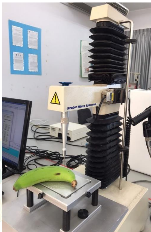
ภาพที่ 43 ทำการเซ็ตเครื่อง Texture Analyser การวัดความแน่นเนื้อโดยเลือกใช้หัวเข็ม ขนาด 2 mm และค่าความเครียดเป็น 50% แล้วนำกล้วยวางบนแท่นและทำการทดสอบ โดยจะทดสอบ 10 ซ้ำ
