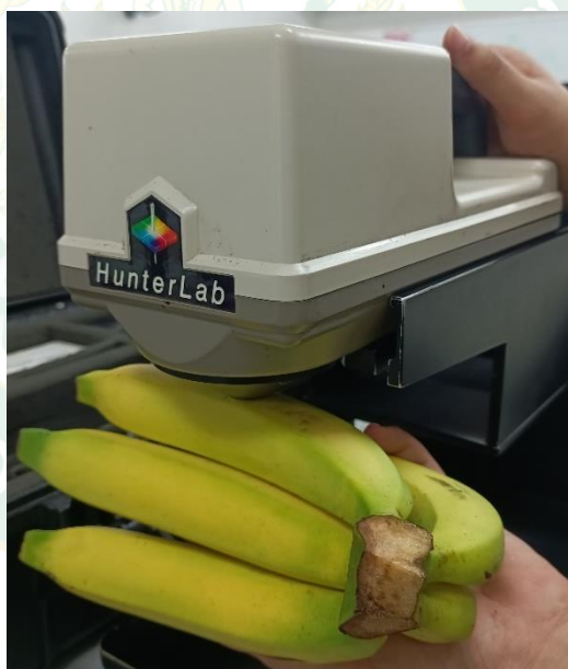
ภาพที่ 42 การวัดค่าสี ทำการวัดผลกล้วยเป็นจำนวน 10 ซ้ำ และทำการหาค่าเฉลี่ย
