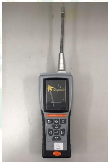
ภาพที่ 48 เซ็นเซอร์แก๊สคาร์บอนไดออกไซด์ (CO 2 )
