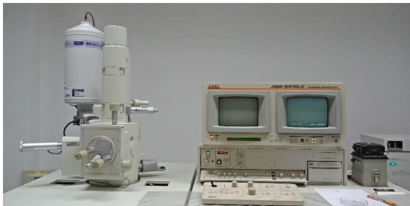
ภาคผนวกที่ 8 กล้องจุลทรรศน์แบบส่องกราด เพื่อใช้ในการศึกษาลักษณะสัณฐานและโครงสร้างภายในของไบโอชาร์
