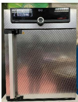
ภาคผนวกที่ 10 ตู้อบลมร้อน (Hot air oven) เพื่อใช้ในการลดความชื้นชีวมวลและไบโอชาร์
