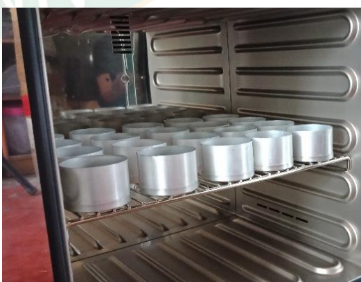
ภาคผนวกที่ 10 ตู้อบลมร้อน (Hot air oven) เพื่อใช้ในการลดความชื้นชีวมวลและไบโอชาร์
