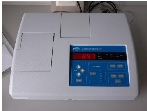
ภาพที่ ค-10 เครื่องวัดความขุ่น (TURBIDIMETER)
