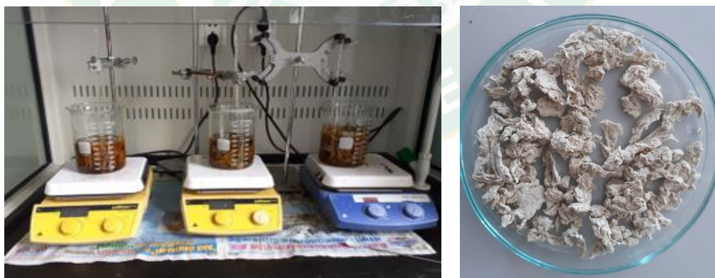
ภาพที่ ค-4 การต้มเยื่อกระดาษฟางข้าวโดยใช้โซเดียมไฮดรอกไซด์ ในห้องปฏิบัติการ
