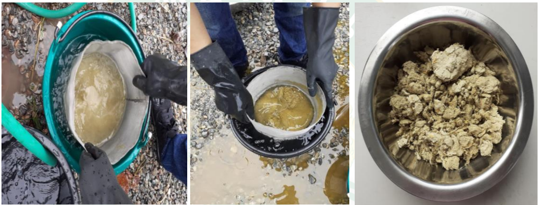
ภาพที่ ค-5 การต้มเยื่อกระดาษฟางข้าวในหม้อต้มโดยใช้โซเดียมไฮดรอกไซด์ และการล้างเยื่อ
