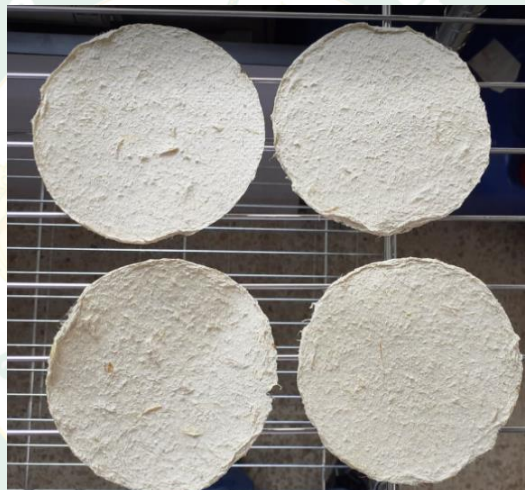
ภาพที่ ค-11 แผ่นกระดาษที่หาความขุ่นของน้ำที่ผ่านชุดกรองสุญญากาศ
