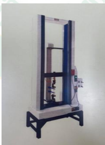
ภาพที่ 23 เครื่องทดสอบความต้านทานแรงดึงของกระดาษ
