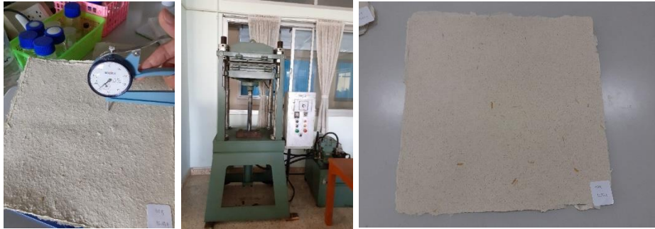
ภาพที่ ค-7 การวัดความหนาและการอัดแผ่นกระดาษด้วยเครื่องอัด
