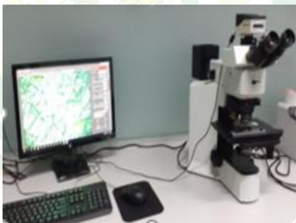
ภาพที่ 17 วิเคราะห์เส้นใยด้วยกล้องจุลทรรศน์แสง (OLYMPUS U-MSSP4 JAPAN)
