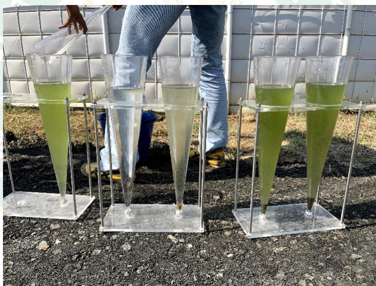
ภาพที่ 6 การวัดปริมาณฟลอกที่ตกตะกอน โดยใช้ Imhoff Cone
