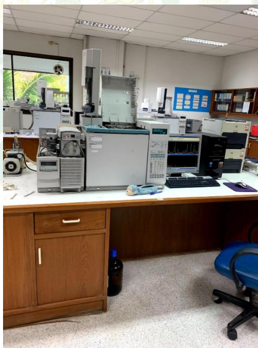
ภาพผนวกที่ 8 ตรวจสอบปริมาณกลิ่นโคลน: จีออสมิน และ เอ็มไอบี ใช้วิธี Gas Chromatography-mass Spectrometry (GC-MS)
