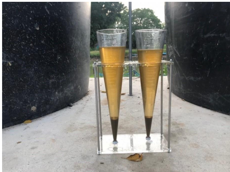
ภาพที่ 9 การวัดปริมาณฟลอคที่ตกตะกอน โดยใช้ Imhoff Cone
