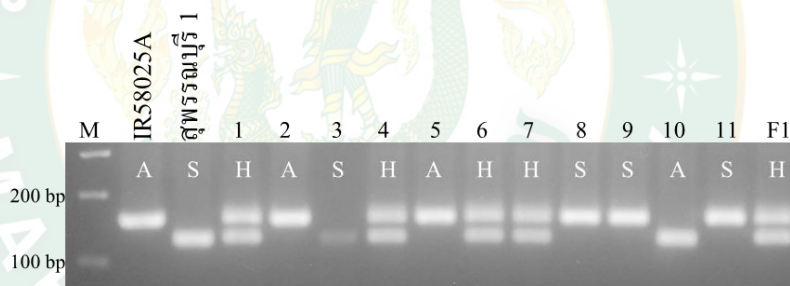
ภาพที่ 22 ผล 3 เพอร์เซ็นต์ อะกาโรสเจล อิเล็กโทรโฟรีซิส ของการเพิ่มจำนวนดีเอ็นเอด้วยไพรเมอร์ RMS_PPR9-4
