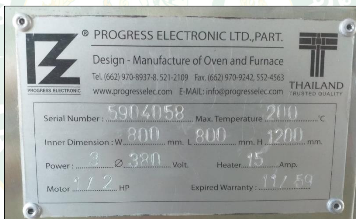
ภาพที่ 26 รายละเอียดเครื่องอบแห้งแบบลมร้อน
