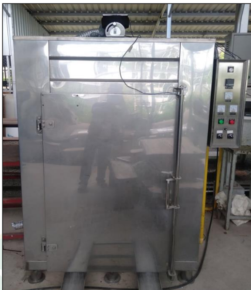
ภาพที่ 25 เครื่องอบแห้งแบบลมร้อนที่ใช้ในงานวิจัยนี้
