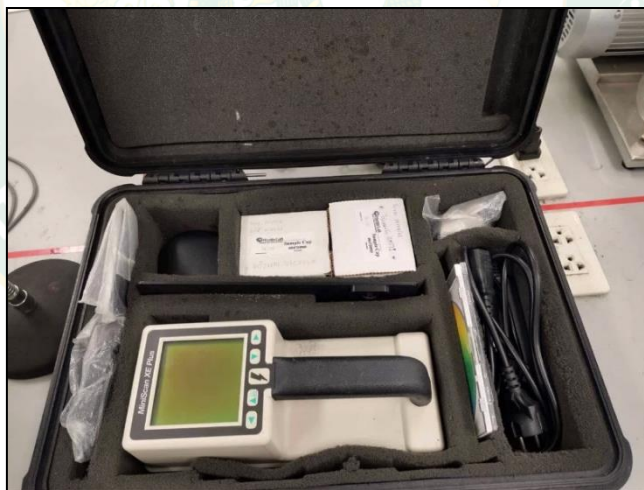
ภาพที่ 29 เครื่องวัดความเข้มของแสง (Spectrophotometer)
