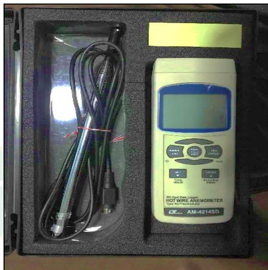
ภาพที่ 56 เครื่องวัดอัตราเร็วลม ยี่ห้อ Lutron รุ่น AM-4215SD แบบ Hot wire
