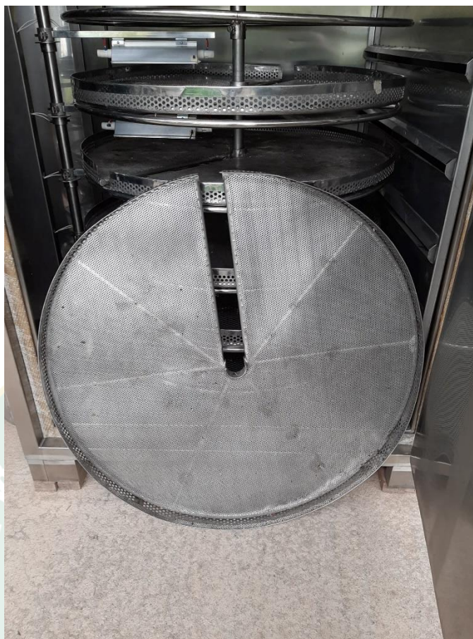
ภาพที่ 28 ถาดอบแห้งแบบวงกลมขนาดเส้นผ่านศูนย์กลาง 90 cm
