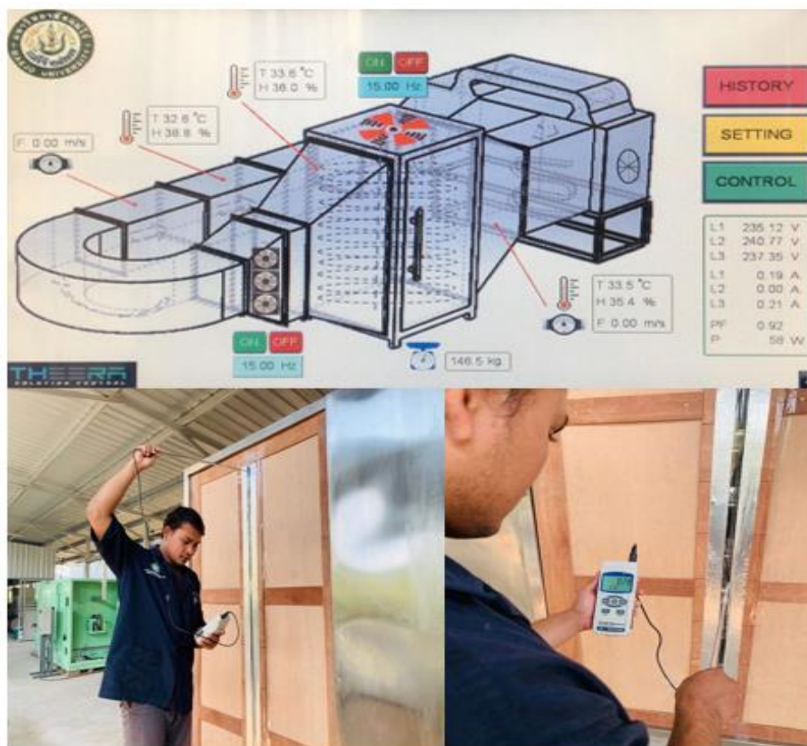
ภาพที่ 38 การติดตั้งประตูกันลมเพื่อจำลองสภาวะการทำงานจริงของเครื่องอบแห้ง และการตรวจวัดค่าพารามิเตอร์ต่าง ๆ
