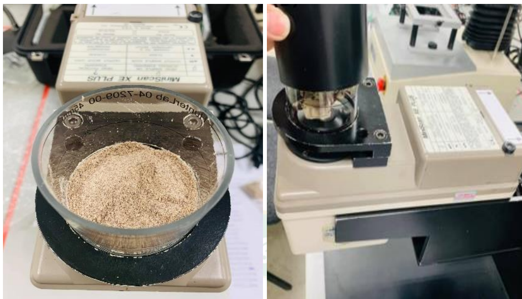
ภาพที่ 45 การวัดค่าสีของผลิตภัณฑ์อบแห้งด้วยเครื่อง Spectrophotometer
