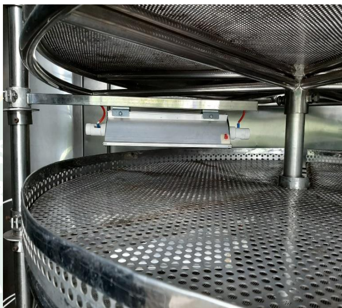
ภาพที่ 23 การติดตั้งหลอดอินฟราเรดไฟฟ้าพร้อมคอมสสะท้อนรังสี
