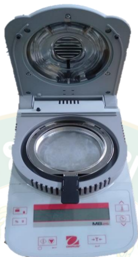
ภาพที่ 62 เครื่องวิเคราะห์ความชื้นยี่ห้อ Ohaus รุ่น MB25
