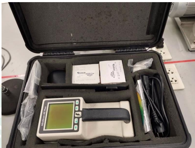
ภาพที่ 64 เครื่องวิเคราะห์ค่าสี ยี่ห้อ Hunter lab รุ่น Mini Scan XE Plus
