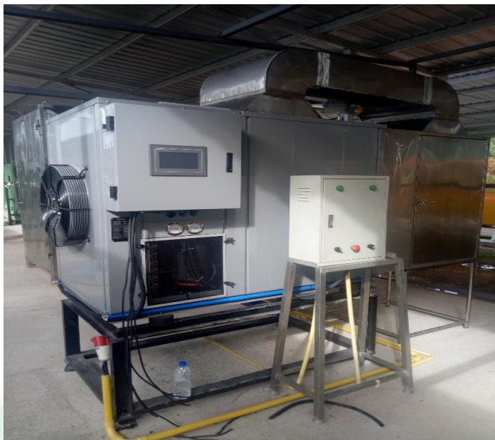
ภาพที่ 18 ป้อนความร้อนขนาดกำลังการผลิตความร้อน (Heating capacity) 10.5 kW
