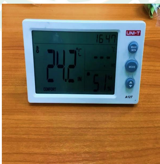
ภาพที่ 55 เครื่องวัดอุณหภูมิและความชื้นสัมพัทธ์ ยี่ห้อ Uni-T รุ่น A12T
