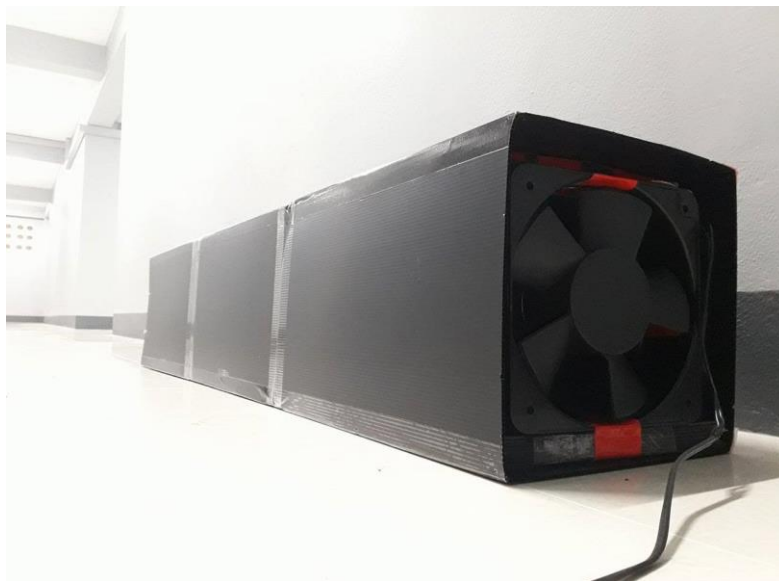
ภาพที่ 40 อุโมงค์ลมที่ใช้ในการทดสอบกังหันลมขนาดจิ๋ว
