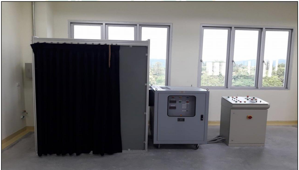
ภาพที่ 34 เครื่องกำเนิดแสง (Solar simulator)
