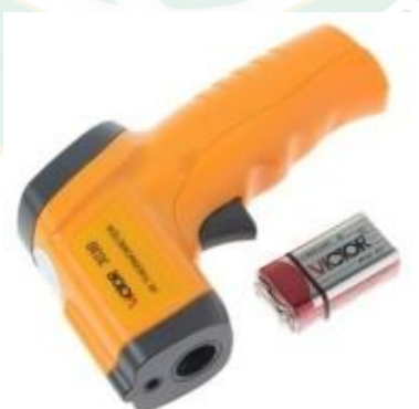
ภาพที่ 36 เครื่องวัดอุณหภูมิแบบอินฟราเรด ยี่ห้อ VICTOR รุ่น 303B
