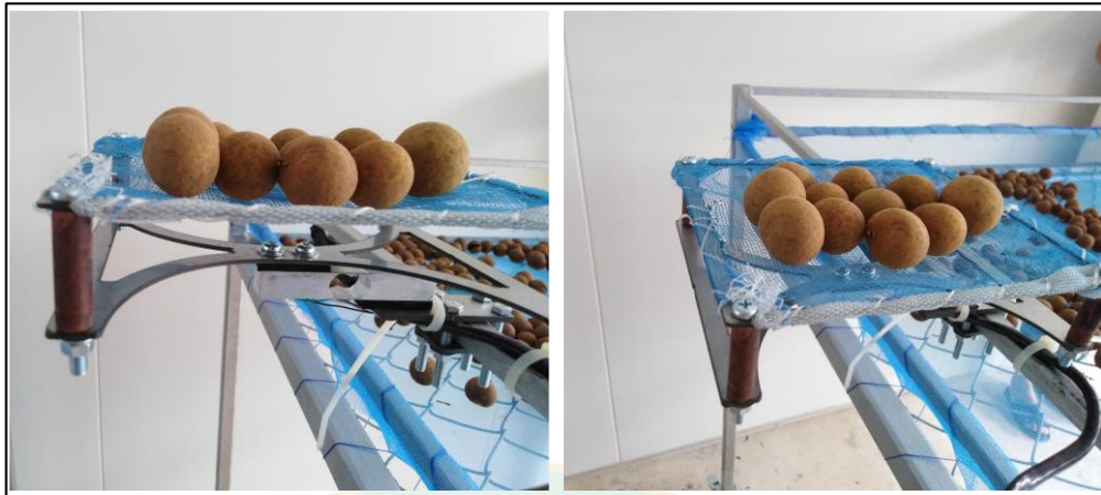
ภาพที่ 42 อุปกรณ์วัดน้ำหนักตัวอย่างผลิตภัณฑ์ภายในห้องอบแห้ง
