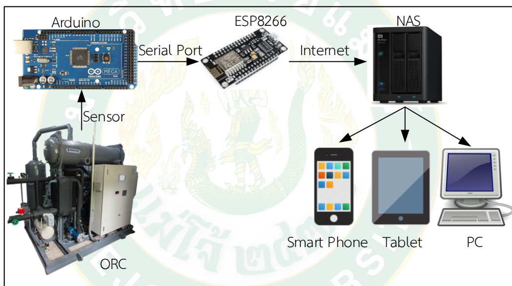
ภาพที่ 13 ผังแสดงการเชื่อมต่อข้อมูลวัฏจักรแรงคินสารอินทรีย์แสดงผลผ่านระบบอินเทอร์เน็ต
