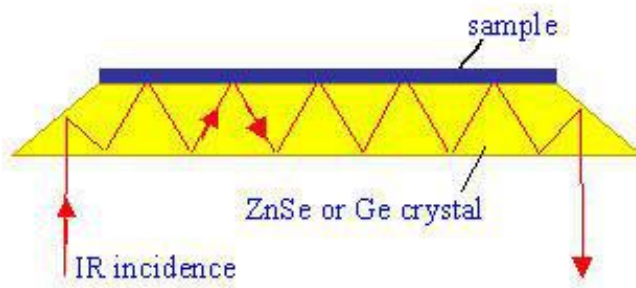
ภาพที่ 19 การสะท้อนแสงแบบ multiple internal reflection
