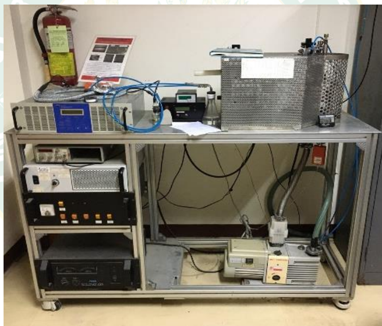
ภาพที่ 29 ระบบพลาสมาความดันต่ำ (LPP) ณ ห้องปฏิบัติการศูนย์วิจัยฟิสิกส์ของพลาสมาและลำอนุภาค อาคารนิวตรอน คณะวิทยาศาสตร์ มหาวิทยาลัยเชียงใหม่
