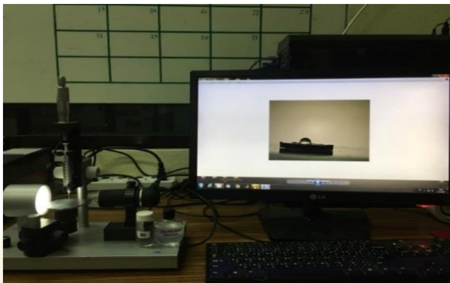
ภาพที่ 34 การทดสอบการวัดค่ามุมสัมผัสของหยดน้ำบนตัวอย่างแบ่งข้าว
