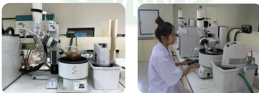
ภาพที่ 10 การระเหยน้ำส้มสายชูหมักจากเนื้อผลกาแพด้วยเครื่องระเหยแบบสุญญากาศ
