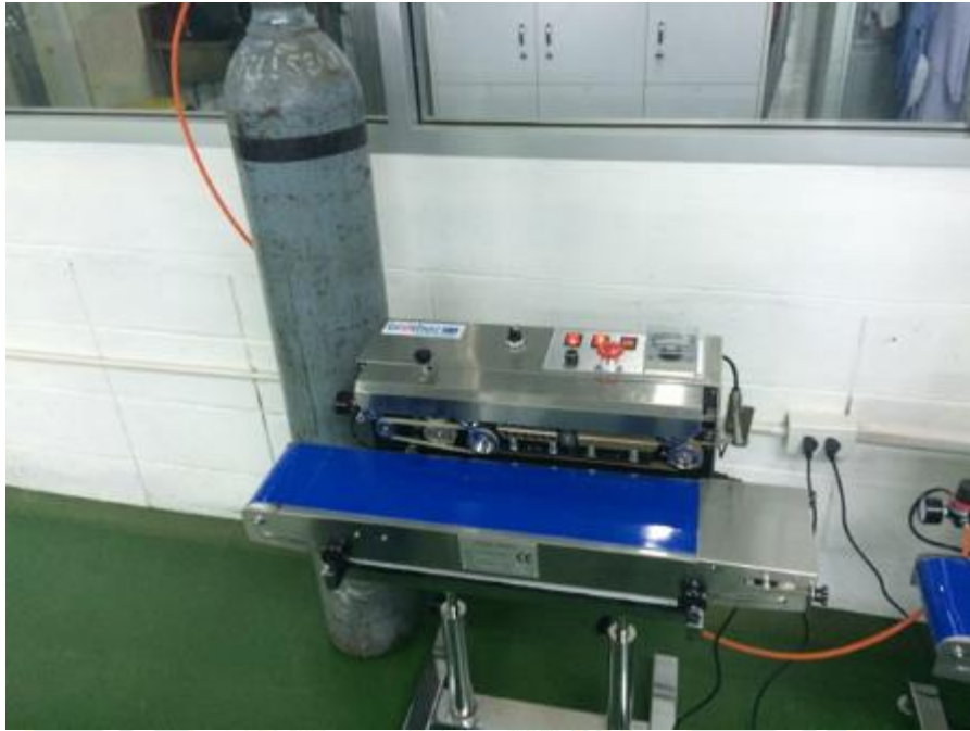
ภาพที่ 6 เครื่องซีลและเติมไนโตรเจนสายพานต่อเนื่อง
